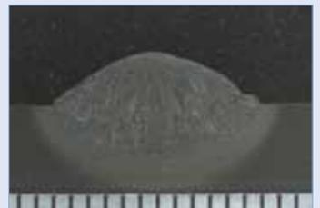
*Soldaduras en acero al carbono utilizando arco rociado normal. HC-1018 de MATHESON *Select*® (izquierda) evidencia mejoras en la forma de la soldadura, en comparación con la soldadura realizada con 75%Ar / 25%CO<sub>2</sub> (derecha).*
